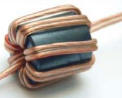
Beim Aufwickeln von Netzkabeln ist zu beachten, dass stromführende Leitungen immer mit beiden Stromrichtungen durch den Kern geführt werden. Möglichst so viele Windungen, wie die Kabeldicke zulässt, jedoch nicht mehr als 20.
