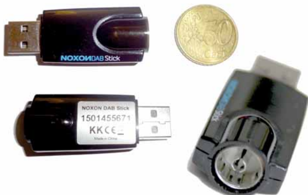
Bild 1: Mit passender Software fungieren preiswerte DAB- bzw. DVB-T-Sticks für den USB-Port als SDR-Empfänger
