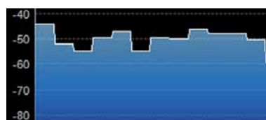
Bild 5: Empfang einer Direkt-Frequenz im 2-m-Band. Ein Haken bei „Correct IQ“ ist empfehlenswert, um durch DC-Anteile hervorgerufenen Spiegelfrequenzempfang zu unterdrücken
